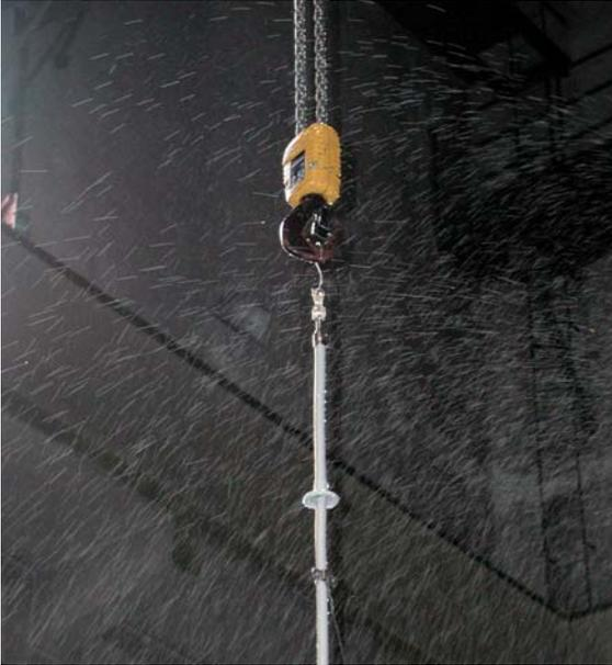
Fig. 5.7.1.3: Prueba de tensión vertical bajo lluvia.
